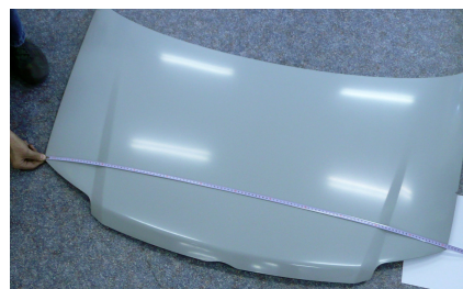
pomiar szerokości maski „jasnej”
