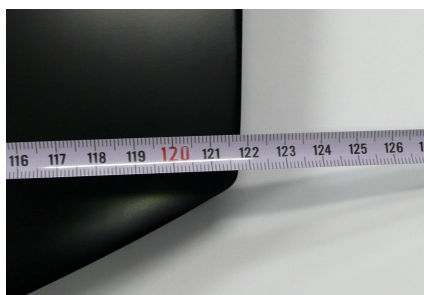
wynik pomiaru maski „ciemnej” 1218 mm
